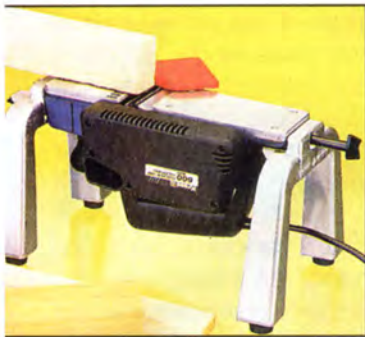
Приспособление-подставка для стационарного применения электрорубанка в качестве фуговального устройства.
