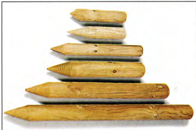
Колышки изготавливают из хвойной древесины (ели, пихты) разной длины в зависимости от предназначения.
