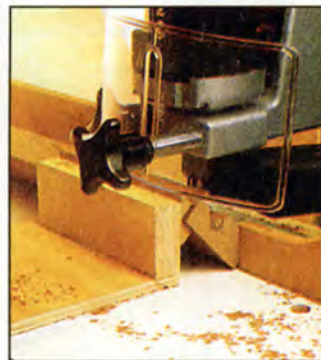
Простое приспособление позволяет обрабатывать наклонённую деталь. Для смазки деревянных направляющих годится воск от обычных свечей.
