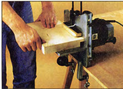
Простой универсальный столик позволяет установить фрезерную машинку в нужное положение и использовать её как настольный электроинструмент.
