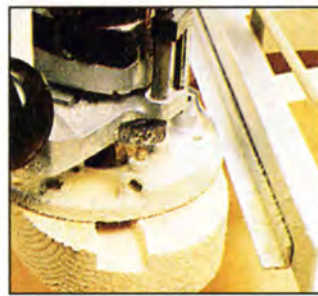
Алюминиевый профиль используется в качестве дополнительной направляющей при фрезеровании паза на пласть заготовки.
