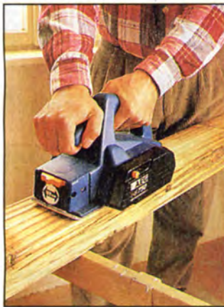
Рустикальная обработка пласти заготовки электрорубанком, оснащённым специальными профильными ножами.
