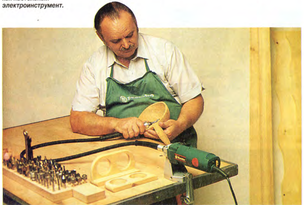
Гибкий вал установлен на электропривод фрезерной машинки.
