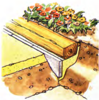
Двухкантный брус со стороны клумбы контактирует с землёй, а со стороны садовой дорожки его подпирают бордюрные камни.
