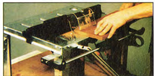
Универсальный стол позволяет использовать ручные дисковые пилы, электродрели, электролобзики, угловые шлифовальные и фрезерные машинки в качестве стационарного оборудования.
