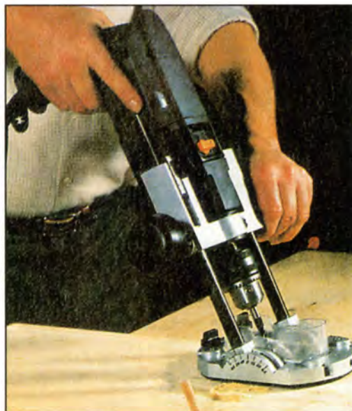
Регулируемая подставка с поворотными направляющими и перемещающейся по ним кареткой с электродрелью предназначена для выполнения сверлильных и простых фрезерных операций.
