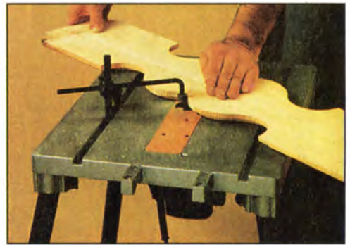
Комбинированный стол для стационарного использования фрезерных машинок, ручных дисковых и торцовочных пил.
