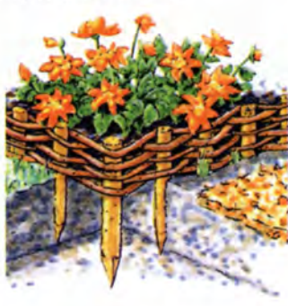
Схема изготовления плетёного ограждения клумбы.
