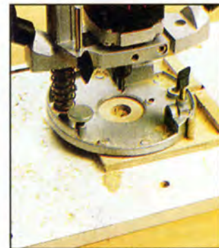
Используя самодельное приспособление, в деталях сверлят отверстия под шканты с помощью фрезерной машинки.
